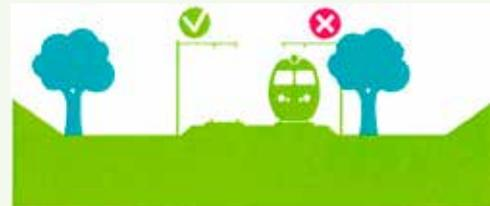
\*la caténaire est un ensemble de câbles porteurs de structure métallique aérienne et de câbles conducteurs destinés à l'alimentation des trains électriques par captage du courant
